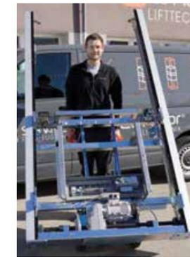
El montaje es posible en un día y no se necesita una grúa. A partir de 1,3 m, los carriles se seccionan. El elevador puede transportarse incluso a través de puertas con una anchura de paso de 90 cm.
